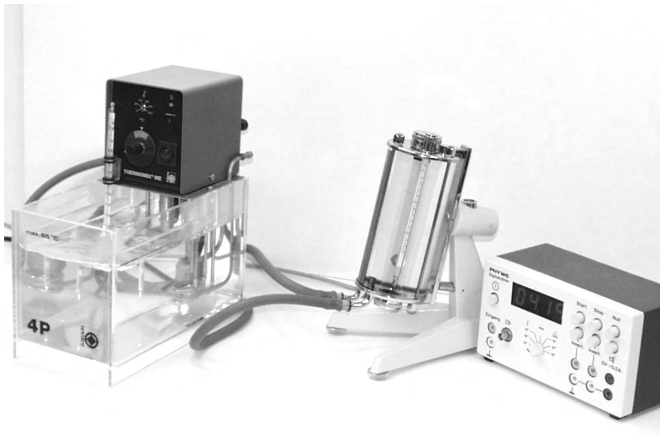
Slika 1. Viskozimetar s padajućom kuglicom
