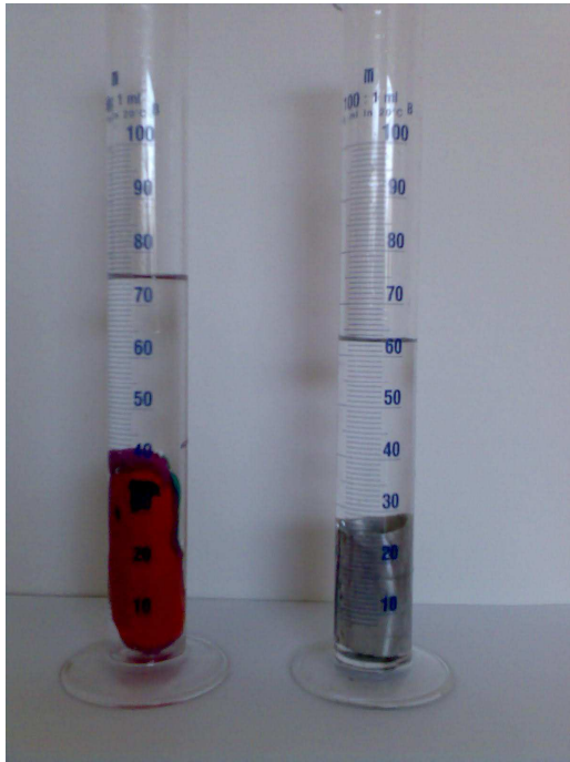
Slika 5.3: Određivanje volumena metala i plastelina istih masa menzutom.
