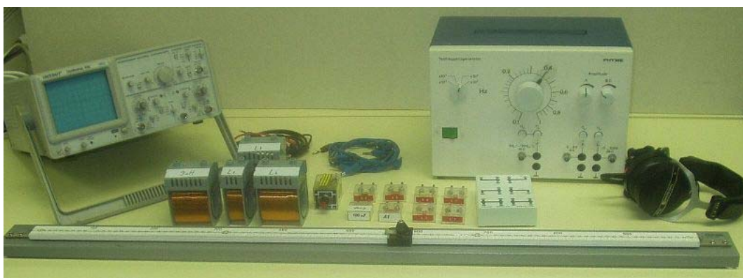
Slika 9. Elementi mjernog postava za LC most
